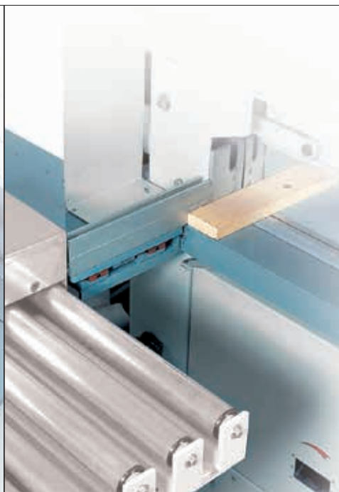
Botola espulsione rifili di testa e scarti di coda di tagli dritti (aperta)
